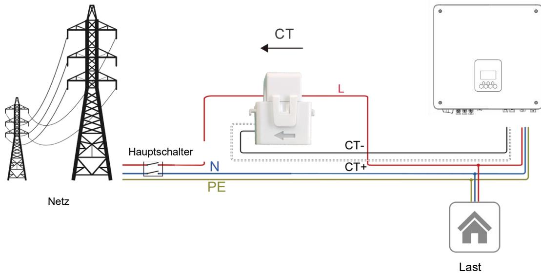
Wenn ein weiterer Generator im Haus vorhanden ist, kann CT2 verwendet werden, um die vom Generator erzeugte Leistung aufzuzeichnen und die Daten zur Überwachung an die Website zu übertragen.
