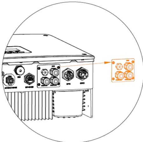
Schritt 2: Bereiten Sie ein Standard-Netzwerkkabel und einen Kabelstecker vor und führen Sie dann das Netzwerkkabel durch den Kabelstecker.
