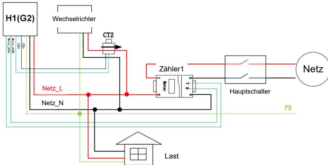
**Achtung: Bitte führen Sie die Verdrahtung strikt nach dem unten stehenden Diagramm durch und vertauschen Sie nicht die Positionen von Zähler1 und Zähler2 in der folgenden Lösung für die Verdrahtung von zwei Zählern, da dies zu unvorhersehbaren Fehlfunktionen bei der Datenaufzeichnung führen kann. Sie können Zähler1 oder Zähler2 aus der Verpackung des Zählers erkennen. Die Standard-Modbus-Adresse für Zähler1 ist 1, die Standard-Modbus-Adresse für Zähler2 ist 2.**
