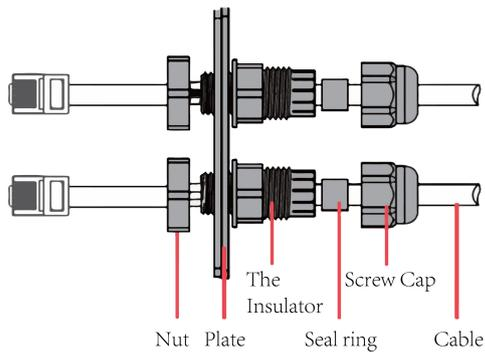
Schritt 3: Stecken Sie den Kabelstecker in den DRM/COM-Port an der Unterseite des Wechselrichters und schrauben Sie ihn fest. Stecken Sie dann die andere Seite des Netzkabels in den PC oder ein anderes Gerät.
