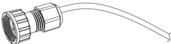
Schritt 2: Crimpen Sie das Kabel mit einem Rj45-Stecker, der sich im Inneren des Kabelanschlusses befindet.
