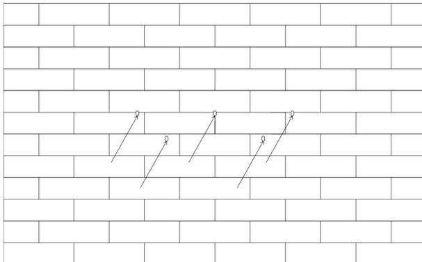
Stecken Sie die Dehnungsrohre in die Löcher und ziehen Sie sie fest. Montieren Sie die Halterung mit den Dehnschrauben.
