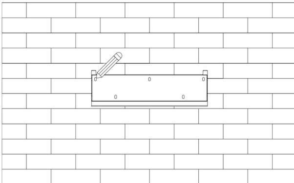
Bohren Sie die Löcher mit einer elektrischen Bohrmaschine, stellen Sie sicher, dass die Löcher mindestens 50 mm tief, und ziehen Sie dann die Dehnungsrohre fest.
