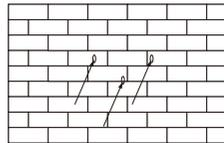
Stecken Sie die Dehnungsrohre in die Löcher und ziehen Sie sie fest. Montieren Sie die Halterung mit den Dehnschrauben.
