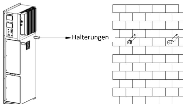
Bohren Sie die Löcher an den Markierungen mit einem Bohrer mit einem Durchmesser von 6 mm. Setzen Sie die Dehnschrauben in die Löcher ein.
