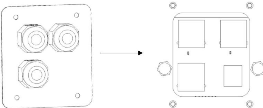
Schritt 2: Bereiten Sie ein Standard-Netzwerkkabel und einen Kabelstecker vor und führen Sie dann das Netzwerkkabel durch den Kabelstecker.
