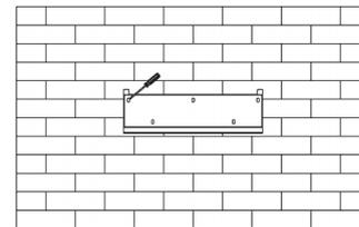
Schritt 2: Anpassen des Wechselrichters an die Wandhalterung
